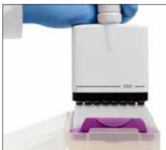
При установке наконечника на дозатор будьте осторожны и пользуйтесь специальным механизмом Optiload.
