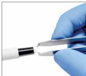
Защитные фильтры предохраняют дозатор от контаминации, и их необходимо регулярно менять.
