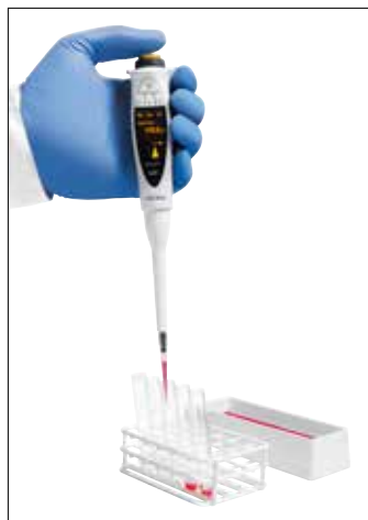
В процессе набора жидкости держите дозатор в вертикальном положении.
